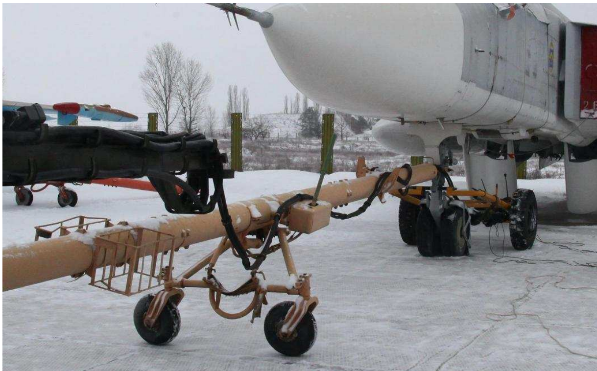
Рисунок 3. Экспериментальные исследования работы кривошипного транспортировочного устройства на заснеженной опорной поверхности
