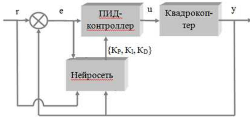
**Рис. 1. Схема системы с самонастраивающимся ПИД-регулятором**
