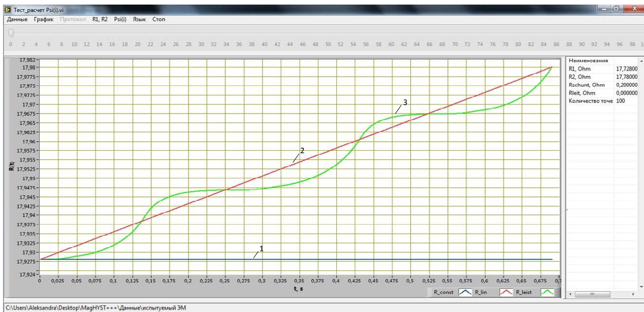
Рисунок 2 – Различный характер изменения активной составляющей сопротивления обмотки электромагнитного механизма, принимаемый при расчете его вебер-амперной характеристики (1 - постоянное сопротивление, 2 - линейное сопротивление, 3 – сопротивление, изменяющееся в зависимости от выделяемой тепловой энергии)
