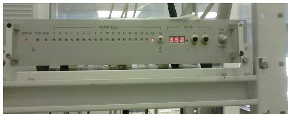
Рисунок 1. Имитатор двигательной установки
