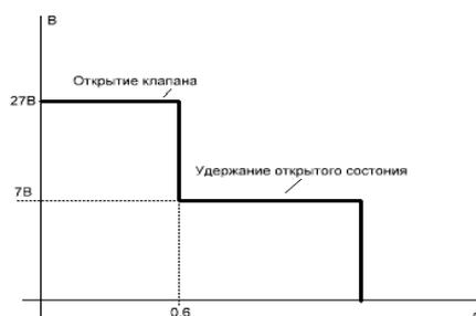
Рисунок 3. Команда на включение клапанов двигателя
