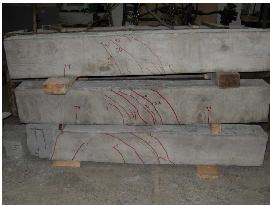
Рис. 4. Балки после испытаний (снизу – вверх): железобетонная, фиброжелезобетонная (1,5%), фиброжелезобетонная (3%).
