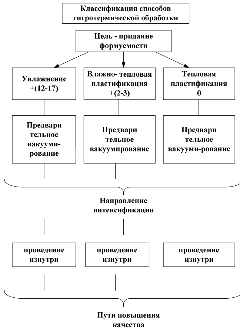
Рисунок 1. Классификация способов гигротермической обработки для придания обувным материалам свойств формуемости и направления их интенсификации
