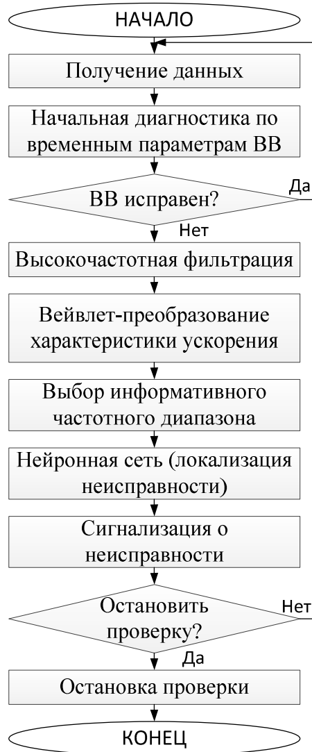
Рис. 1. Двухэтапный алгоритм для диагностики высоковольтного коммутационного оборудования
