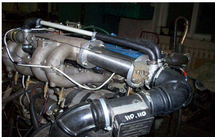
Рис. 2. Общий вид двигателя с установленной модернизированной впускной системой.
