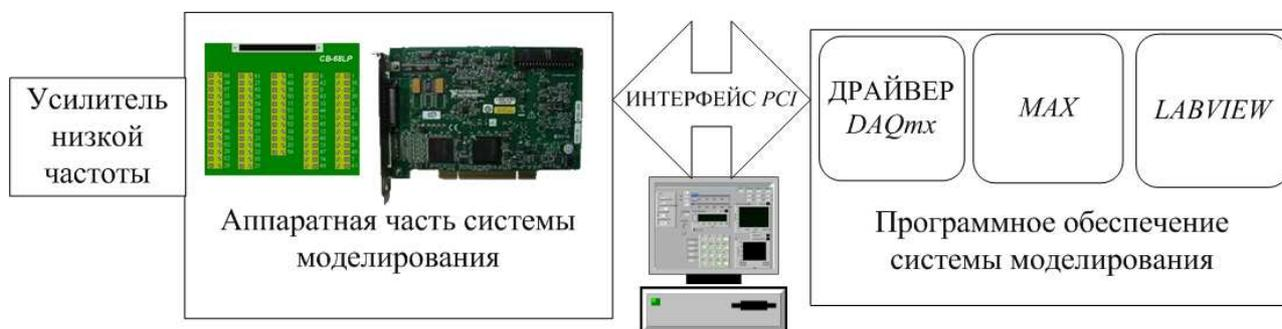
Рисунок 4 – Реализация устройства оценки качества функционирования усилителей низкой частоты на основе использования программ *LABVIEW* и плат *DAQ*
