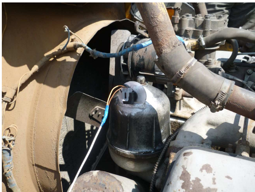
Рис. 6. Центрифуга с устройством контроля на двигателе ЯМЗ-240Б
