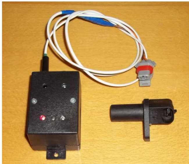
Рис. 3. Указатель с преобразователем и датчик
