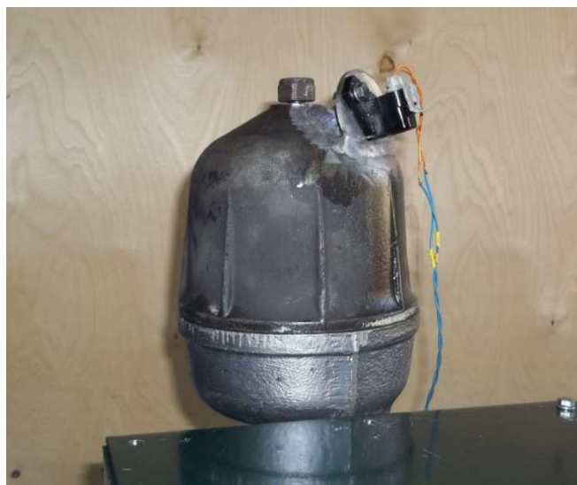
Рис. 4. Центробежный фильтр двигателя ЯМЗ с датчиком
