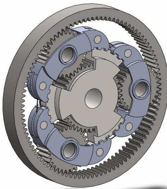
Рисунок 5 – Планетарная передача с «тросовым соединением»
