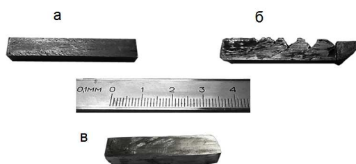
Рис. 2. Общий вид образцов для проведения прессования: (а) исходный, (б) фрагментированный образец после неоптимального режима прессования, (в) после оптимального режима РКУП
