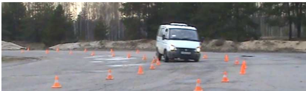
Рис. 4 – Фрагмент сертификационных испытаний «вход в поворот»
