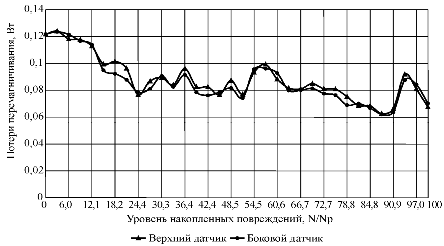
Рис. 2. Зависимость потерь перемангничивания от цикловой нагрузки для стали 12ХМ на основной гармонике.
