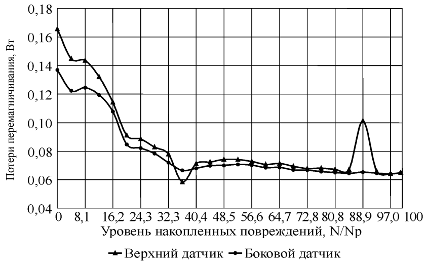
Рис. 3. Зависимость потерь перемангничивания от цикловой нагрузки для стали 12ХМ на основной гармонике при концентраторе диаметром 1,5 мм.
