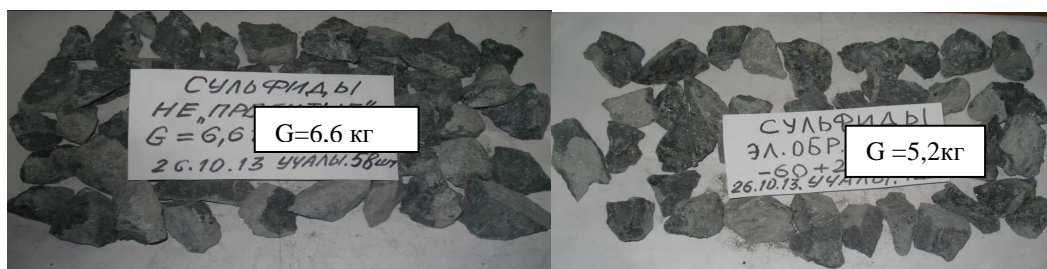
Рис.4. Образцы забалансовой медно-цинковой руды перед дроблением
