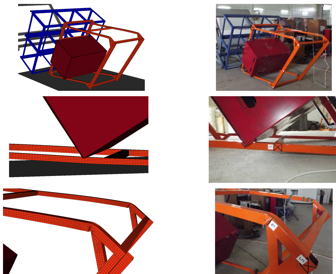
Рис. 5. Картины деформированного состояния конечно-элементной модели и конструкции
