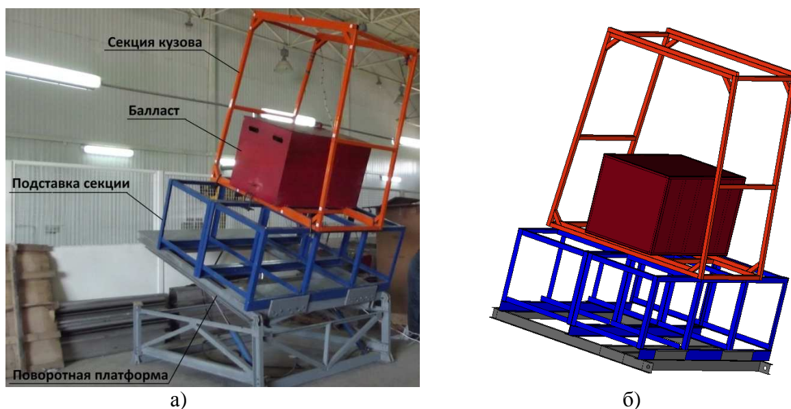
Рис. 2. Фото испытательного стенда с установленной секцией кузова (а) и вид разработанной конечно-элементной модели секции (б)
