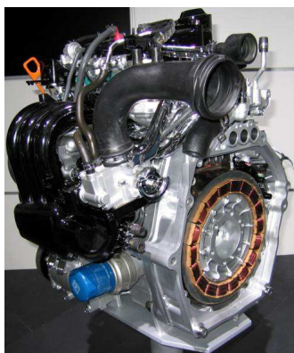
Рис. 2. ДВС автомобиля HondaInsight II с силовым агрегатом IMA
