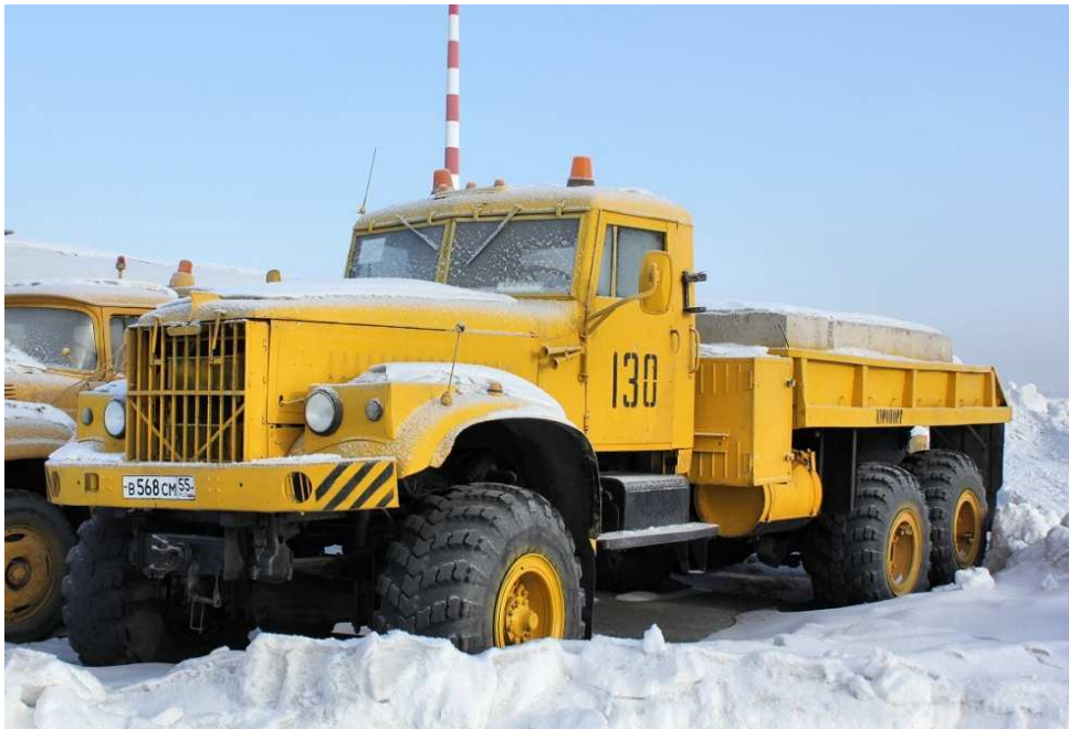
Рис. 1. Аэродромный тягач КраЗ с загруженными плитами
