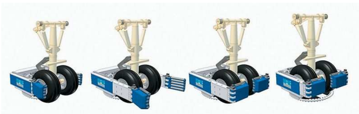
Рис. 2. Принцип захвата передней стойки на безводильных тягачах
