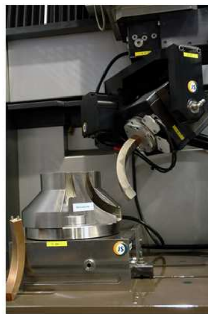
Рис. 4. Применение поворотного стола на копировально-прошивном станке: а – схема стола; б – пример изготовления детали
