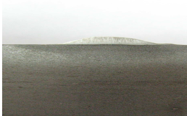
Рис. 5. Макрошлиф наплавленного валика на обратной полярности.
