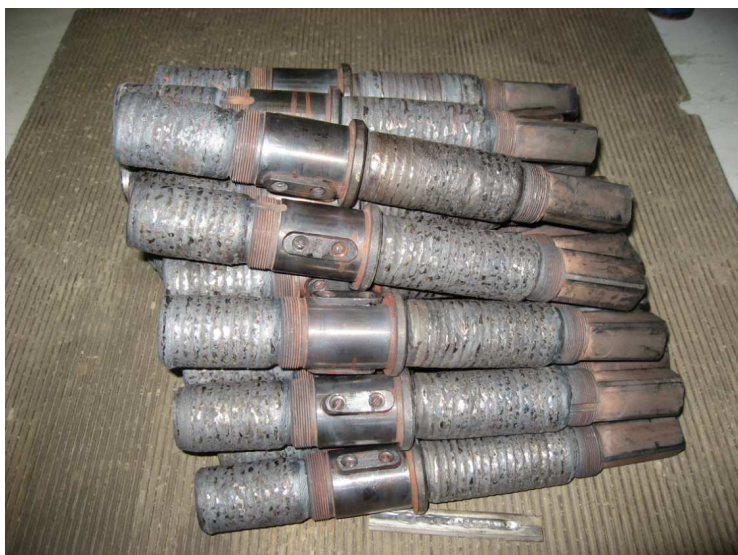
Рис. 6. Вид наплавленных валов прокатных роликов, ток наплавки 80 А.
