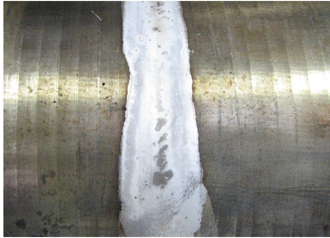
Рис. 4. Образец, подвергнутый катодной очистке.
