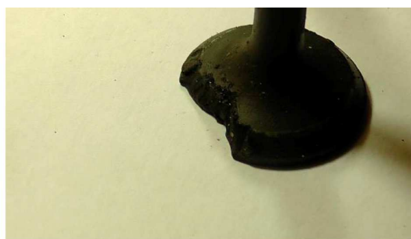
Рисунок 2 – Прогар тарелки клапана как следствие износа пары «седло-клапан»
