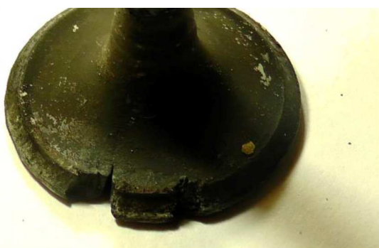
Рисунок 2 – Прогар тарелки клапана как следствие износа пары «седло-клапан»
