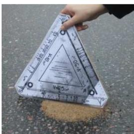
Рисунок – 2 Определение шероховатости методом «песчаного пятна»
