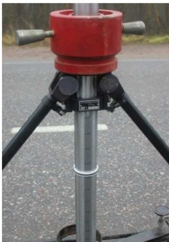
Рисунок – 1 Измерение коэффициента сцепления портативным устройством ППК
