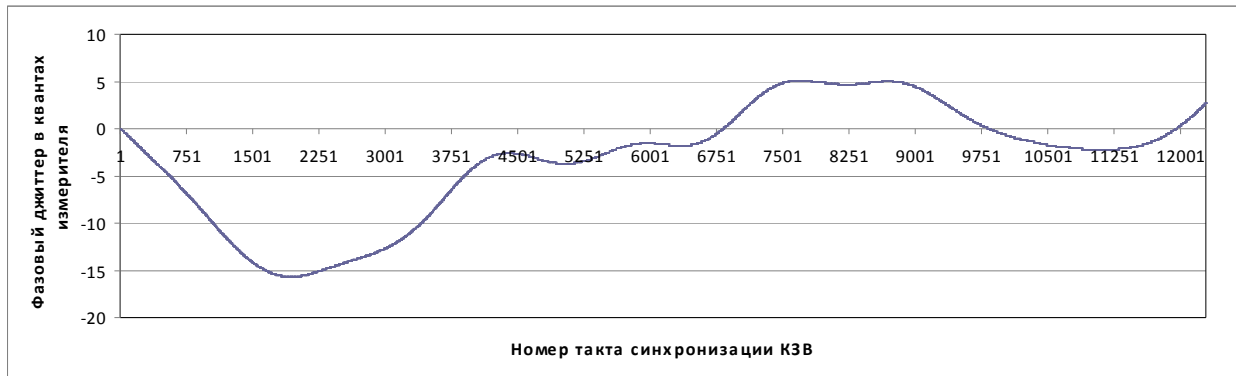
Рисунок 4. График квази-детерминированной фазовой компоненты джиттера
