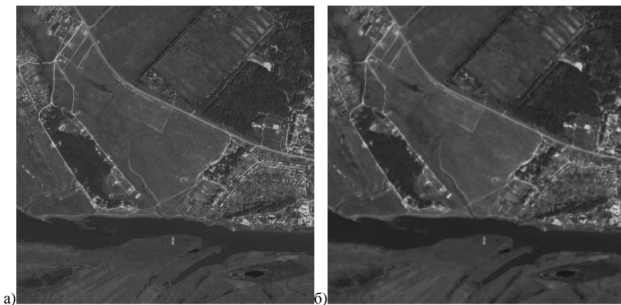
Рисунок 2 – Применение медианного фильтра. а) исходное изображение, б) отфильтрованное изображение (СКО=8,08)
