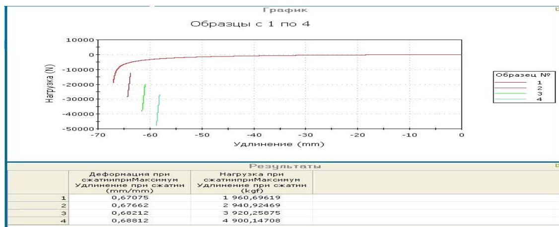
Рис. 9. Схема нагружения керамического порошка с добавкой ВВ (Китай) 30%
