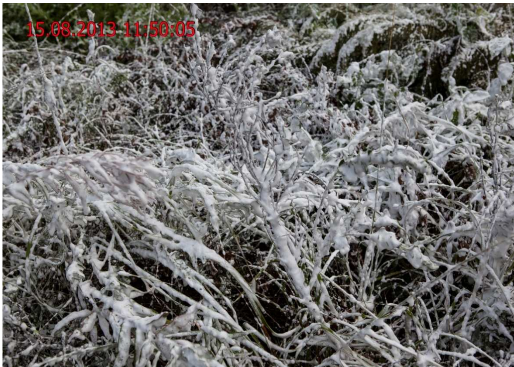
Рис. 2. Внешний вид компрессионной пены (сухой) на поверхности растительности через 4 минуты после подачи ее на растительный покров
