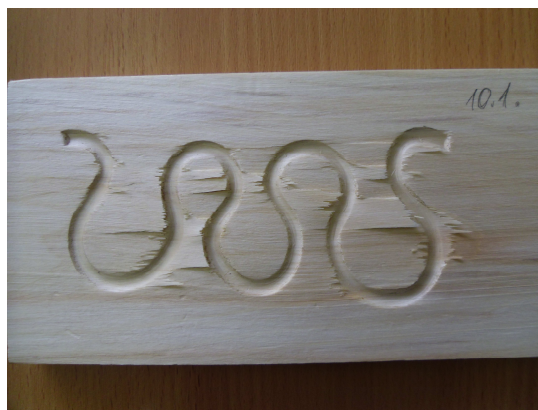
Рис. 5 Рельеф на поверхности древесины липы после прессования
