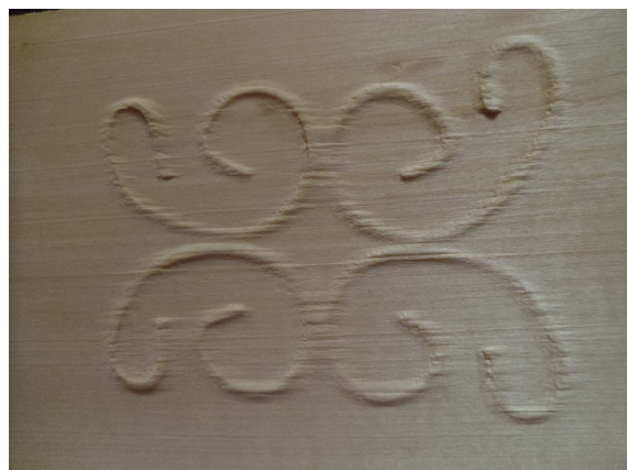
Рис.3 Рельефный рисунок на поверхности детали из древесины липы после восстановления волокон
