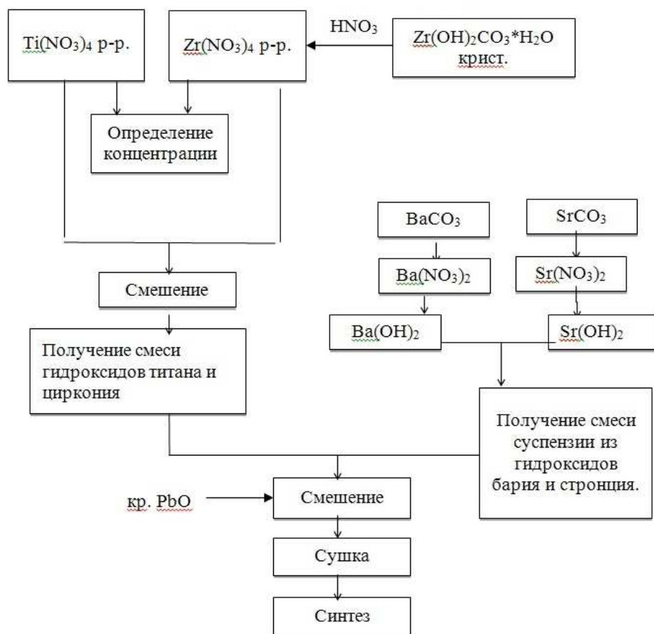
Рисунок 1 - Принципиальная технологическая схема синтеза пьезокерамического ЦТБС-3 с использованием активных прекурсоров.
