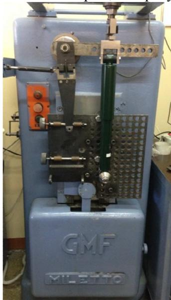
Рис.4. Двухтрубный гидравлический амортизатор (передней подвески семейства ВАЗ 2101...07) на стенде «Miletto» в момент испытаний
