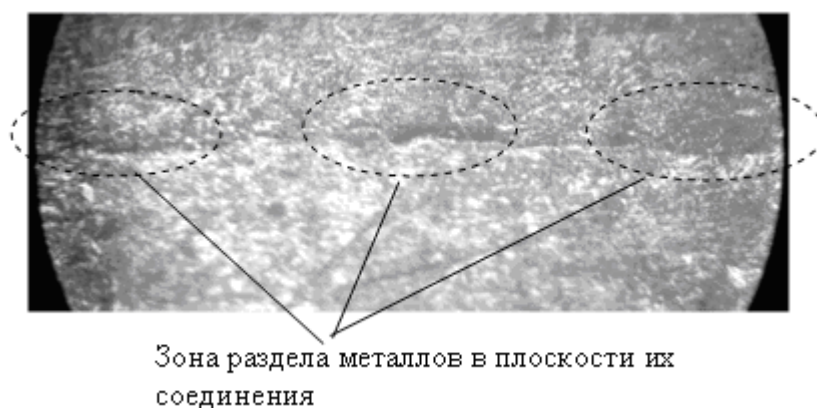
Рис. 1. Структура зоны соединения с участками раздела соединяемых металлов (проволока Св-08, деталь сталь 45) (x 140)
