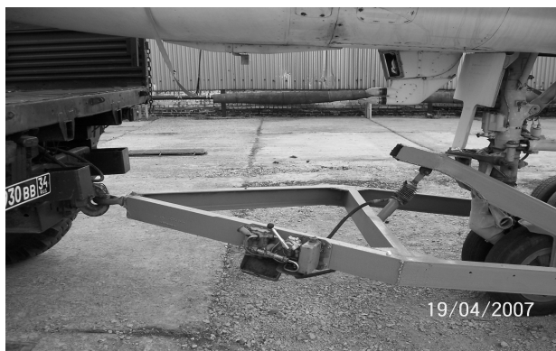
Рис. 4. Аэродромная буксировочная система с устройством для буксировки и эвакуации воздушных судов
