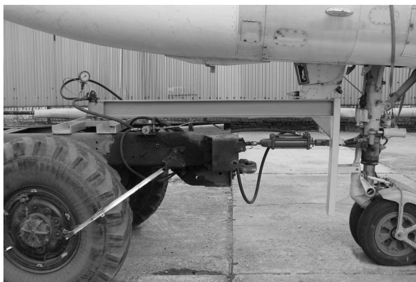
Рис.3. Автоматическое тягово-сцепное догружающее устройство
