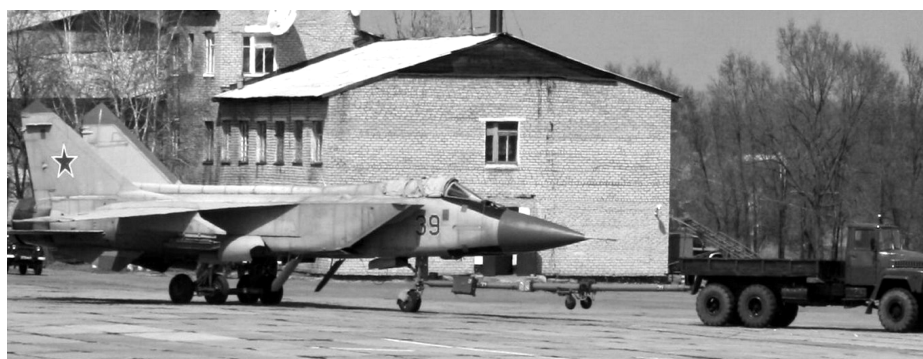
Рис. 1. Буксировка ВС с помощью водила
