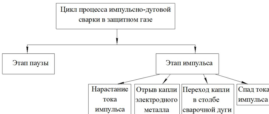
Рис. 3. Схема цикла процесса импульсно-дуговой сварки в углекислом газе
