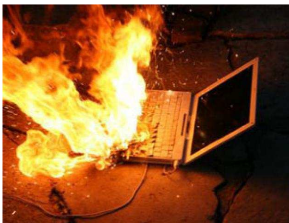
Рисунок 1 – Результат короткого замыкания электродов литий-ионного аккумулятора [6-11]
