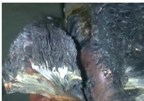
Рисунок 4 – Результат короткого замыкания электродов литий-ионного аккумулятора
