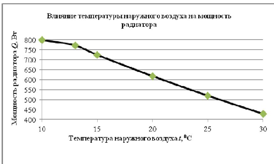
Рис. 2. Влияние температуры наружного воздуха на мощность радиатора.
