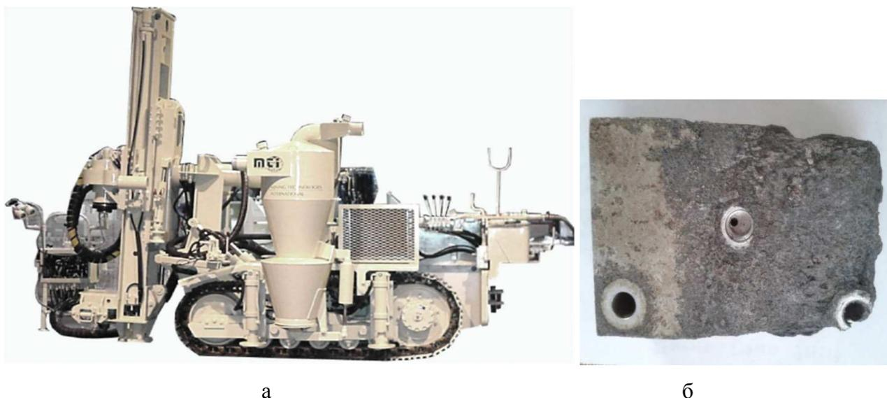
Рис. 1. Буровой станок СММ-2А: а – общий вид, б – клапан управления перемещением, вышедший из строя в результате воздействия агрессивной среды.
