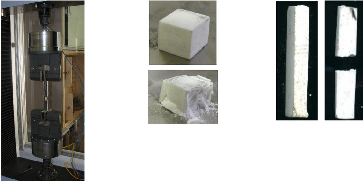
а) Разрывная машина Shimadzu™ AG-50KN б) Образец материала из диоксида алюминия до испытания на сжатие в) Образец материала из диоксида алюминия до и после испытания на изгиб
