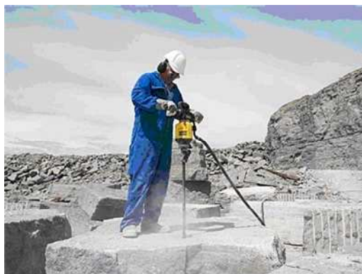
Рис. 3. Бурение шпуров переносным пневматическим перфоратором фирмы Atlas Copco.
