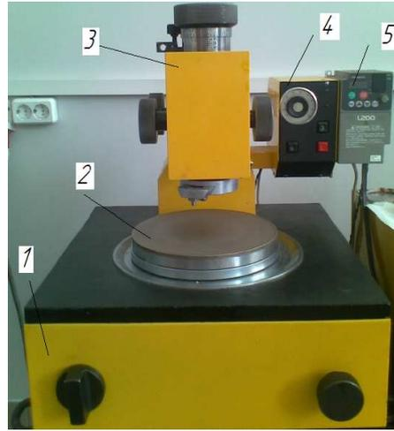
Рис. 5. Плоскодоводочный станок «Растр 220»
