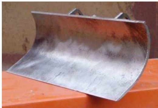
*Рис. 1 Модель отвала автогрейдера ГС 10.06*
