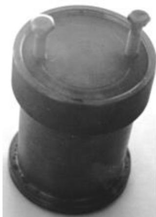
*Рис. 2. Герметичный контейнер объемом 200 мл*
