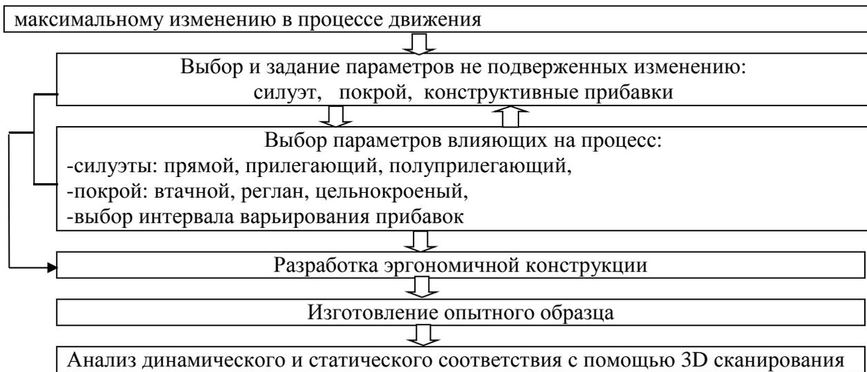
**Рис. 8. Схема проектирования эргономичной одежды с применением технологии трехмерного сканирования**
