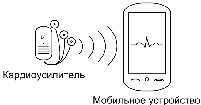
Рис. 2. Состав портативного кардиоанализатора
