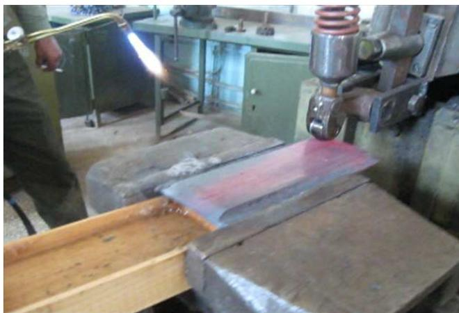
Рис. 2. Фотография процесса накатывания плоской нагретой детали роликом на продольно строгальном станке
