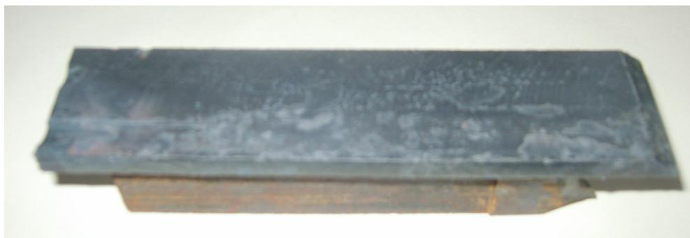
Рис. 3. Пластина после накатывания роликом.
