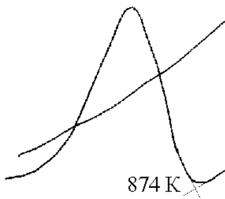
Рис.4. Термограмма рассчитанного эвтектического состава стабильного треугольника системы NaF – KCl – K 2 WO 4 (мол.%)
