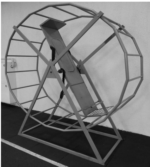
Рис. 1. Тренажёр на развитие вестибулярного аппарата у пожарных
