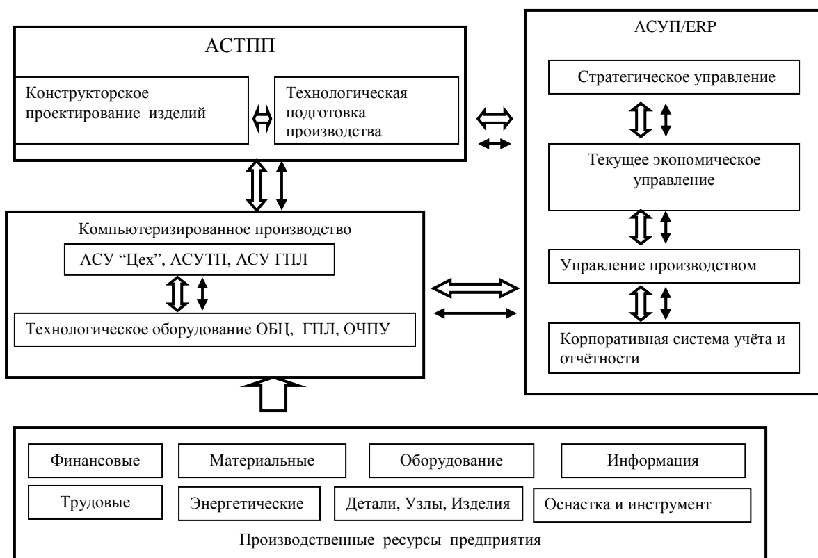
Рис.1. Структурная схема ИАСУП машиностроительного предприятия
