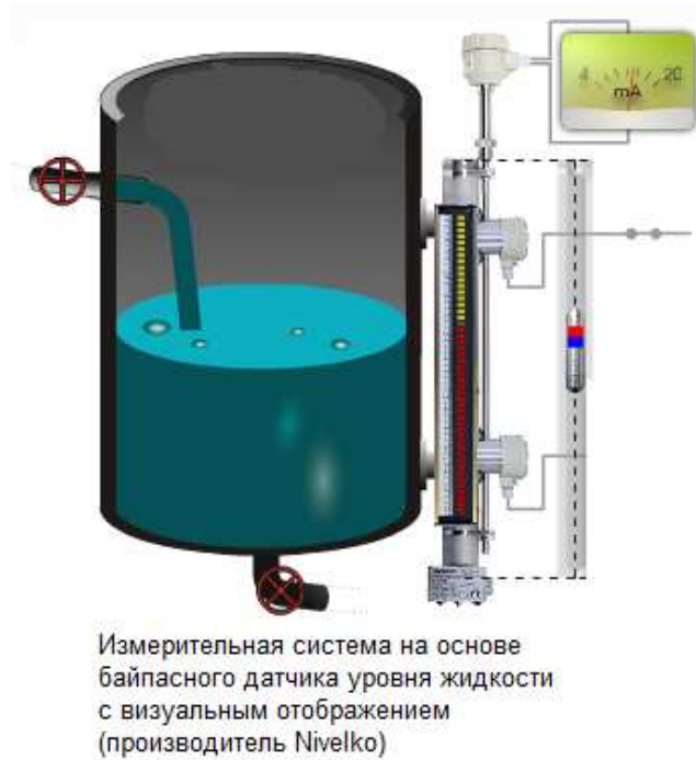
Рисунок 1 – Байпасная измерительная система
