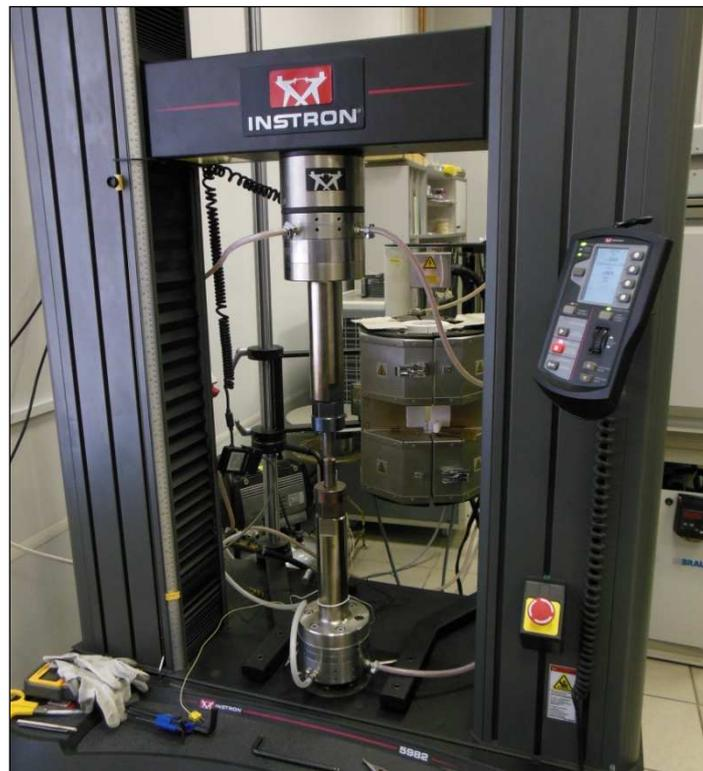
**Рис. 4. Фотография разрывной машины Instron 5982, на которой выполнялись механические испытания образцов из стоматологического материала полиметилметакрилат Temp Basic.**
