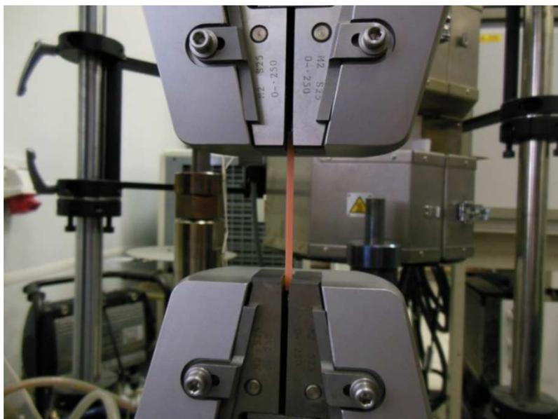
**Рис. 1. Процесс испытаний на растяжение. Образец в виде полоски из полиметилметакрилата ПММА в захватах испытательной машины.**
