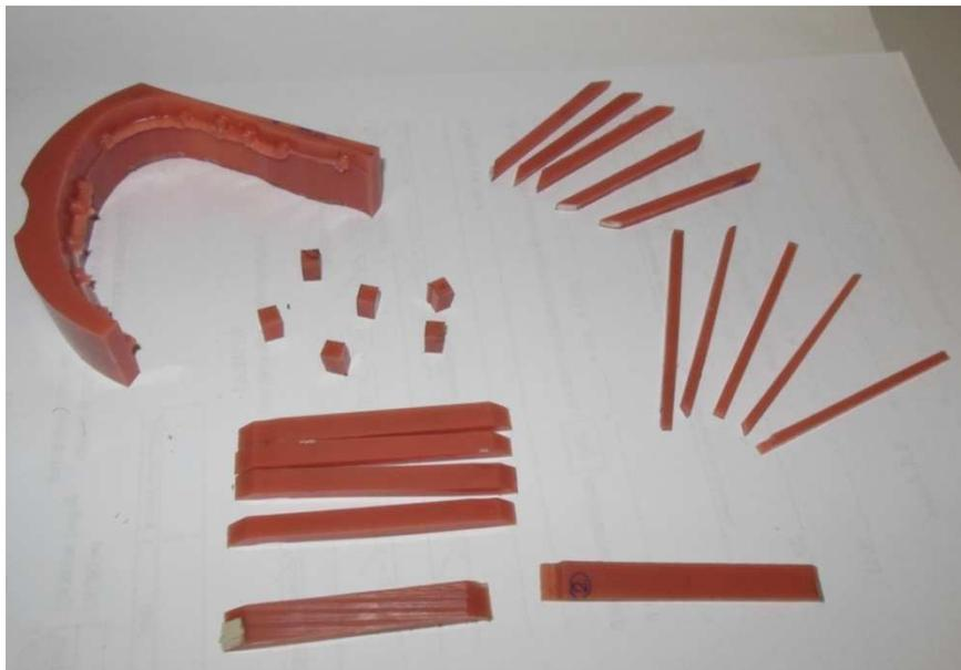
**Рис. 5. Образцы для исследования механических свойств.**
