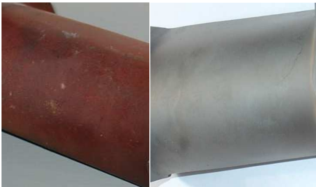
Рис. 2. Удаление окисной пленки с поверхности детали, состояние поверхности: а - до обработки (нагар, технологические загрязнения), б – после обработки.
