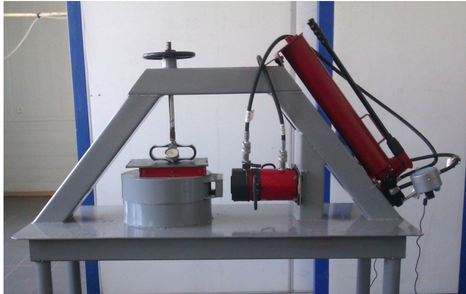
Рис. 2. Стенд для испытания смерзшихся вскрышных пород на сдвиг.
